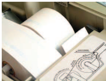
Rys. 2-10. Przygotowanie papieru do zamknięcia osłony drukarki
