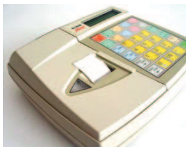
Rys. 2-12. Kasa po wymianie papieru
