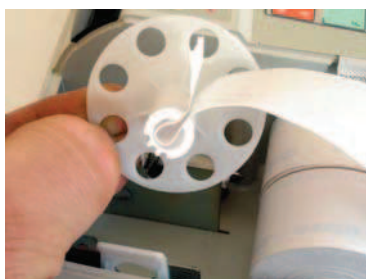
Rys. 2-9b. Zakładanie kopii do zwijacza
