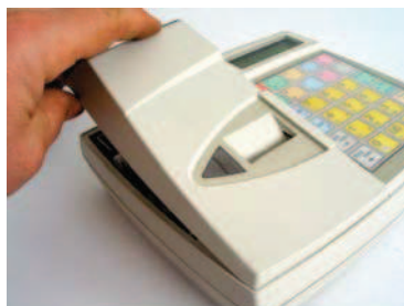
Rys. 2-11. Zamykanie osłony drukarki
