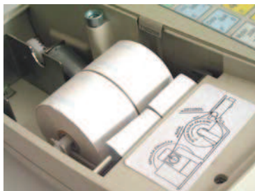
Rys. 2-8b. Zakładanie nowych rolek do rozwijacza
