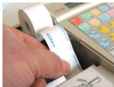
Rys. 2-5. Zakładanie rolki oryginału
