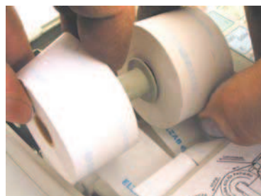
Rys. 2-7. Zakładanie papieru na rolkę rozwijacza
