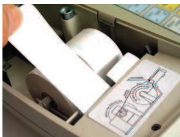
Rys. 2-9a. Zakładanie kopii do zwijacza
