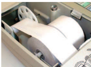
Rys. 2-9d. Zakładanie kopii do zwijacza
