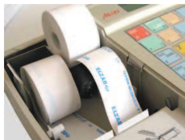
Rys. 2-6. Nowy papier wciągnięty do drukarki
