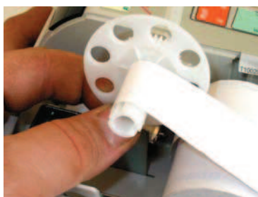
Rys. 2-9c. Zakładanie kopii do zwijacza
