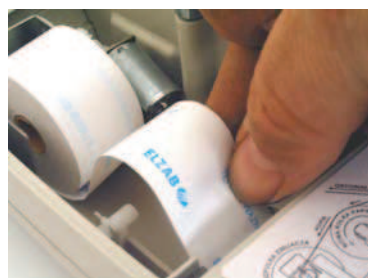
Rys. 2-4. Zakładanie rolki kopii
