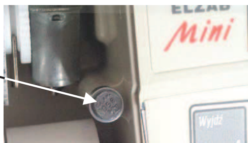
Rys. 2-13. Umieszczenie plomby serwisowej w kasie
