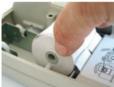
Rys. 2-8a. Zakładanie nowych rolek do rozwijacza
