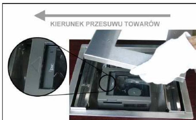
Rys. 16. Czytnik Magellan 2300 HS umieszczony w pomoście
